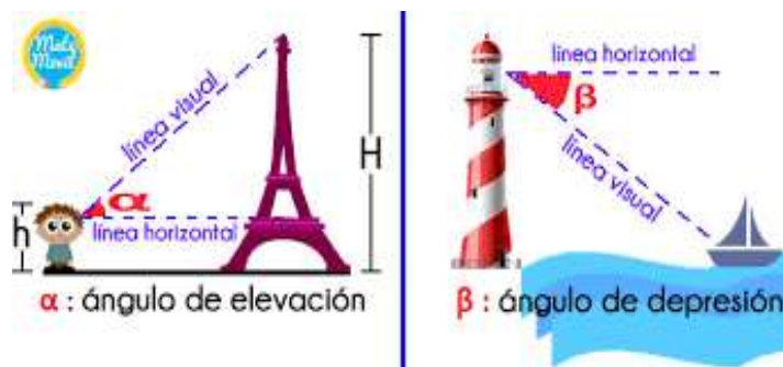
Figura 1. Elementos de los ángulos de elevación y Depresión
