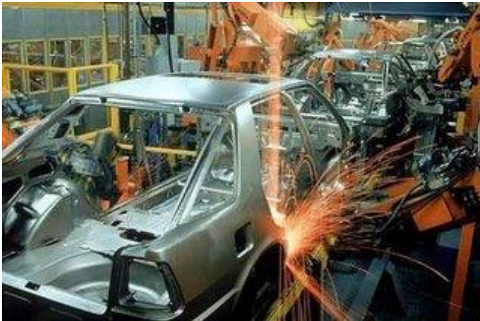
Figura 106. Uso industrial de la soldadura por puntos.
