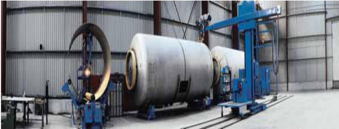
Figura 151. Soldadura G.M.A.W. en un recipiente para gas.
