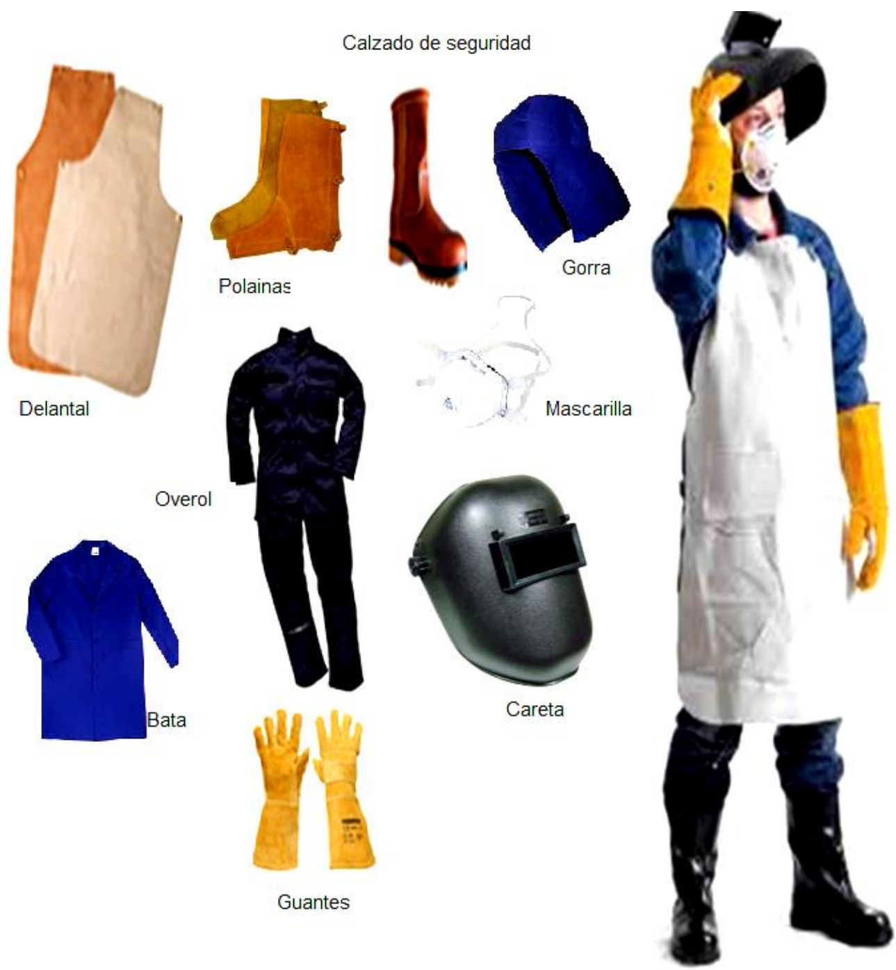
Figura 33. Equipo de protección individual del soldador.
