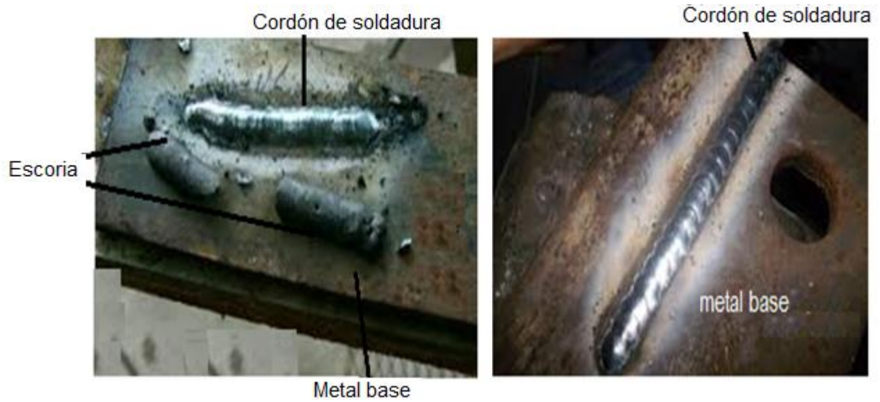
Figura 8. Cordón de soldadura por arco eléctrico.
