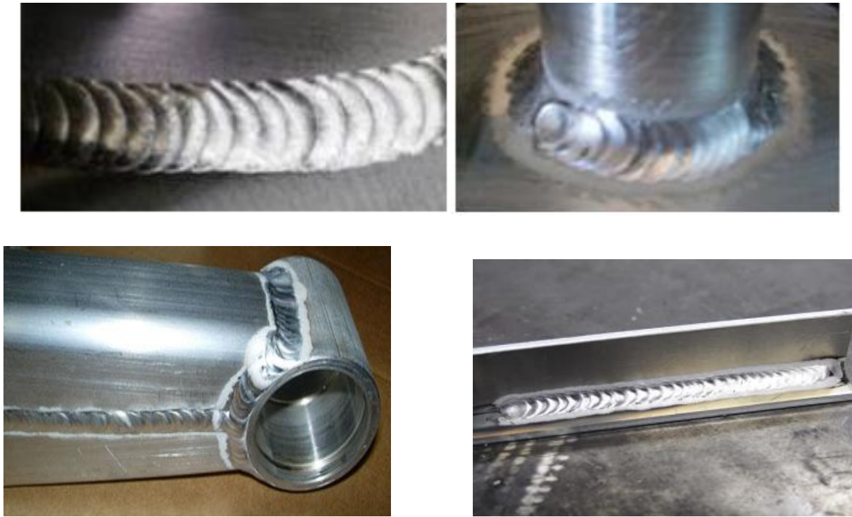
Figura 134. Soldadura de aluminio en el proceso G.T.A.W.
