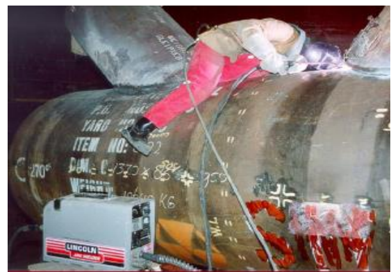
Figura 152. Uso del proceso G.M.A.W. en la unión de partes de barcos petroleros.
